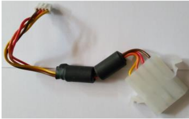
Figura 3: Cable de sintonizador externo MOLEX / JST.
